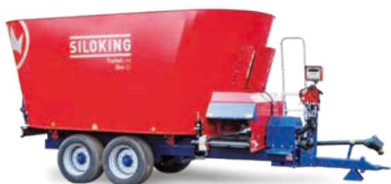
Bendras SILOKING TrailedLine Classic Duo 14-T priekabos aukštis siekia vos 2,45 m.
